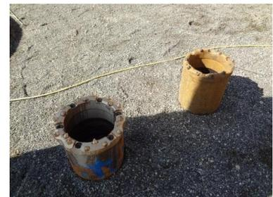
左が掘削前、右が掘削後の先端のドリルです。固い地盤も頑張っって削っています！
