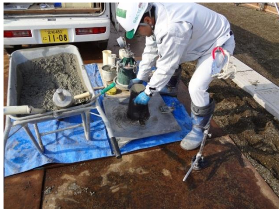
専用の筒にコンクリート充填し、引き上げる。
