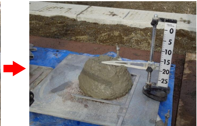
到着したてのコンクリートの一部を試験用に採取する。
