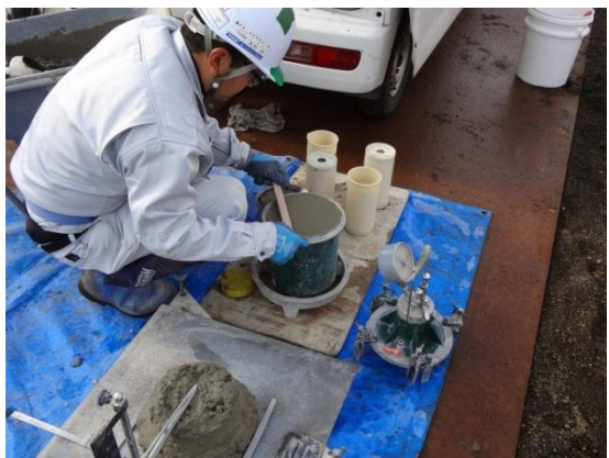
専用の容器にコンクリート充填し、密閉する。
